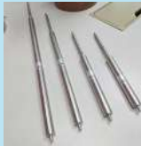
เครื่องมือวัดขนาด diameter ภายในท่อ
